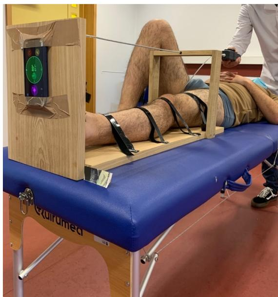
Figura 11 - Medição da ADF no suporte de avaliação utilizando o goniómetro
