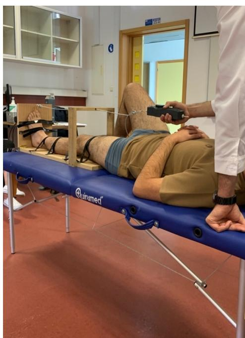
Figura 12 - Medição da ADF no suporte de avaliação com aplicação de uma força perpendicular
